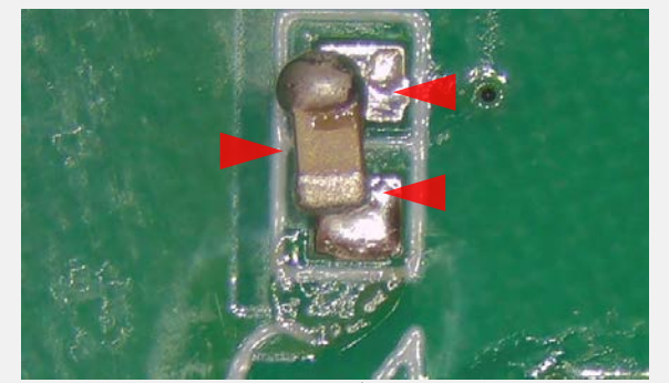
サイドのはみ出し&はんだ不足 IPC-A-610G 8.3.2を参照
